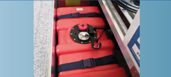
Built fuel tank 43 L with gauge for 530 models / Eingebauter Kraftstofftank 43 L mit Füllstandsanzeige für 530 Modelle
